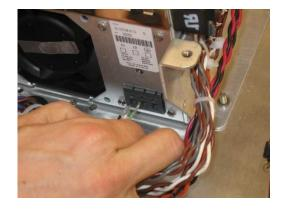
k. Remove Vicor Fan Shield Module.
