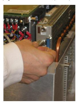
vi. Unplug Red Fan RPM cable, (Cable E).
