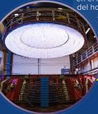
El espejo se coloca en posición vertical para retirar los tornillos y los cilindros hexagonales y poder limpiarlo.
