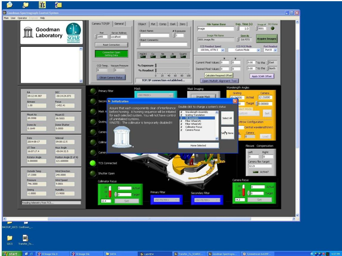
**CUANDO LUZ VERDE NOS INDIQUE QUE ESTA INICIALIZADO EL SLIT ASSEMBLY, PODEMOS SELECCIONAR EL SLIT ADECUADO, DE TAL FORMA QUE EN LA PARTE TRASERA DEL CARRUSEL PODAMOS ACCESAR EL QUE RETIRAREMOS**
